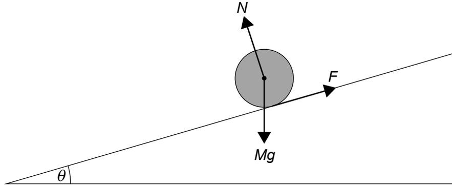
Le schéma ci-dessus montre les trois forces agissant sur ce cylindre.  $N$  est la force de réaction normale et  $F$  est la force de frottement entre le cylindre et la pente.
