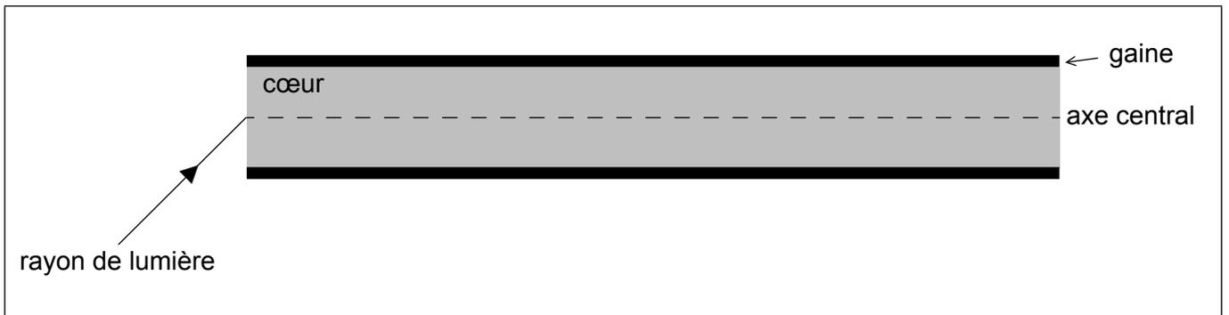
(a) Dessinez le trajet du rayon tandis qu'il se propage à travers la fibre optique à gradient d'indice.
