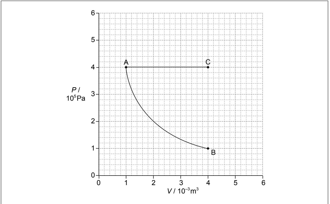
La température en A est 350 K. Une masse identique du même gaz monoatomique parfait subit une transformation isobare de A à C.
